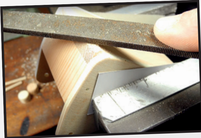
6. Préparation du godet Pour préparer le godet, j'ai utilisé une lime à bois et un étau.
